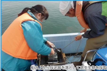
船の上から採泥器を落として底生生物を採取
