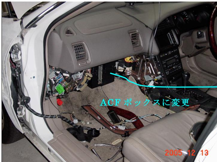
図 5 (1) 車内エアフィルターボックスの改造
