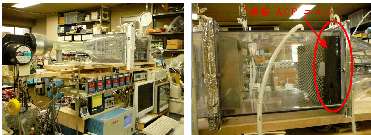
写真6 小型風洞内にセットした“薄型 ACF ユニット”
