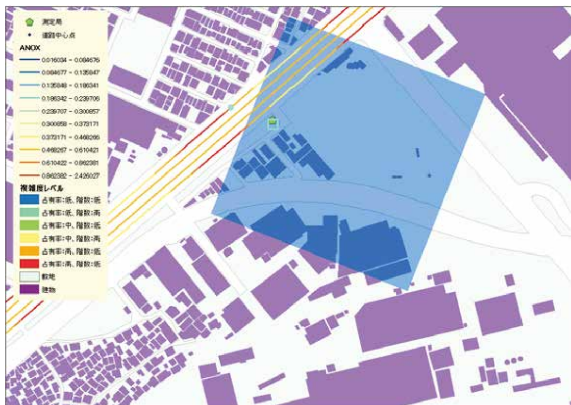
図 23(2) 評価メッシュと近傍道路から作成される周辺構造物の複雑度判定領域例 (池上新田公園前局、丸が道路中心点、四角が評価メッシュ)
