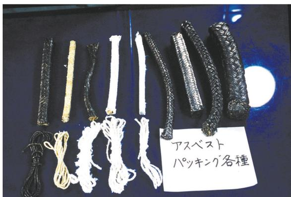
に連動する箇所)に使用される)や、ガスケット(配管などのフランジ部分に固定され、動くことがない場所に使用される)などのジョイントシートは、ゴムと石綿を主原料とし、石綿含有量は主に65%以上でした。ほとんどはクリソタイルが使用されていましたが、1974年以前の耐酸性シール材には、クロシドライトも使用されていました。2006年9月1日から一部の限定された用途のみ使用が許可されましたが、2012年3月1日から完全に製造・使用は禁止されました。
