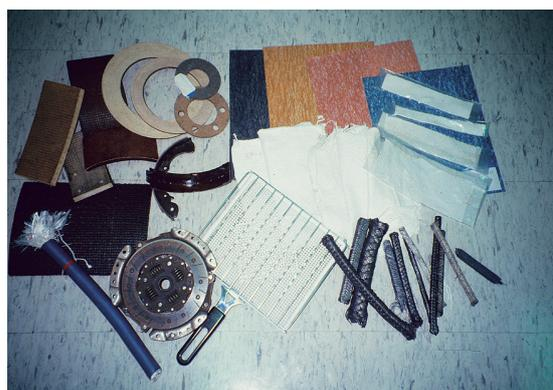
石綿紙は、ソーダ用電気隔膜、電気絶縁材、ビニール床タイルの裏打ち材(1987年に使用中止)などに使用されてきました。
