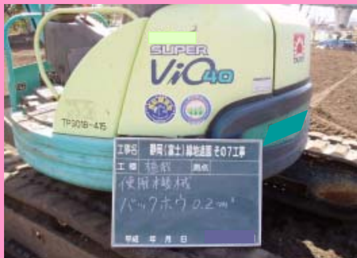
k. 低騒音型・排出ガス対策型建設機械の使用
