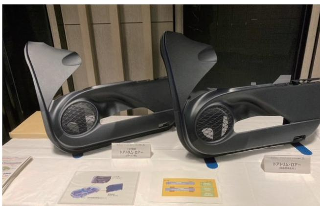
バージン材と再生材で製作した自動車部品の比較(ドアトリムローア)
