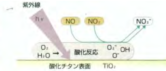
図4 光触媒によるNO x 分解のメカニズム
