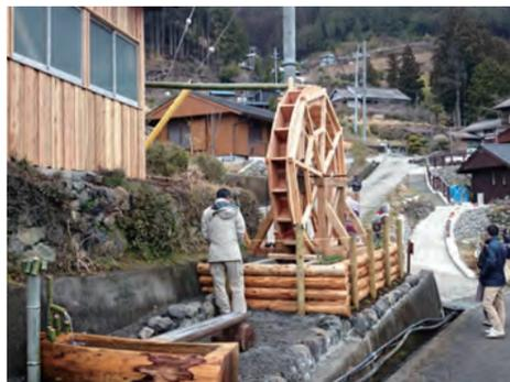
水資源の中でも特に灌漑用水路に着目し、マイクロ水力発電でエネルギーの地産地消を目指した活動。注目すべきは、地域の農業生産団体、自治会などと連携し「水車学習会」「水車作りワークショップ」を継続的に開催していること。2012年度からスタートした本プロジェクトにより、近畿一円の18地域で約50基の水車が稼働している。
