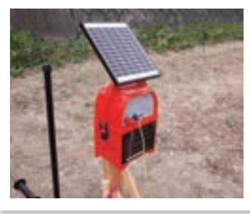
太陽光発電装置のパネルは約30cm四方で12ボルトのバッテリーを内蔵
