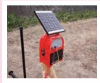
太陽光発電装置のパネルは約30cm四方で12ボルトのバッテリーを内蔵
