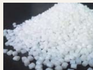
素材の劣化を回復させ、バージン原料と同等の品質になった再生ペレット
