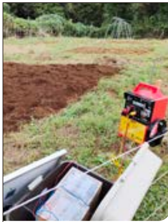
木炭蓄電池は、水に強く、定期メンテナンスも不要。屋外利用に適しているため電気柵でも活用。
