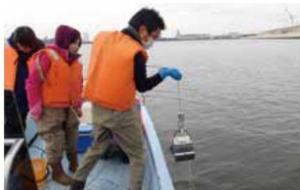
船の上から採泥器を落として底質を採取
