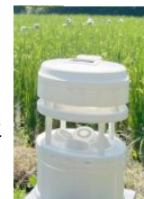
渇水緩和策検討のための気象IoTセンサー 「ソーテナPro」
