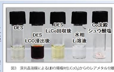
図3 深共晶溶媒によるLIBの陽極材(LiCoO<sub>2</sub>)からのレアメタル分離
