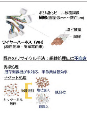
図1 ワイヤーハーネスの仕組み 銅線が塩ビ素材に包まれており、従来の手法では、回収される銅も塩ビも低品位になる。
