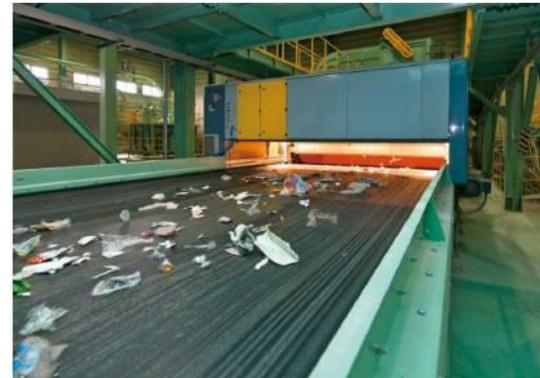
光学センサーによる樹脂素材の選別
