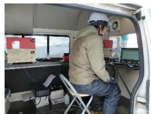
採取ガスのGC-PID測定
