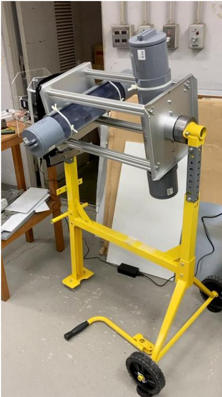
劣化後の試験片を砂や水とともに筒の中に入れ、回転させることで物理的作用を加える。
