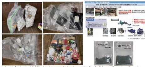
▲回収した資源はベレットにして東北大学のデータバンクへ登録、自動車部品へ活用するための評価分析中
