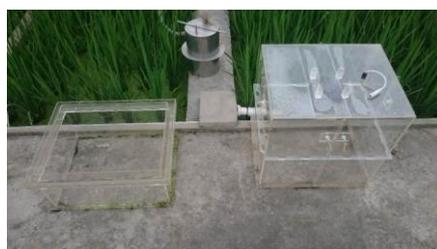
図(2)-8 クローズドチャンバー法で使用した器具 ((a) 土壌に挿入する土台および(b) 土台に載せるチャンナー)
