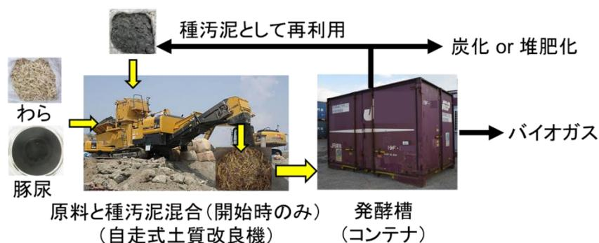
図1 自走式土質改良機とコンテナを利用した簡易型乾式メタン発酵システム
