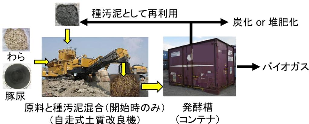
図(1)-7 自走式土質改良機とコンテナを利用した簡易型乾式メタン発酵システム
