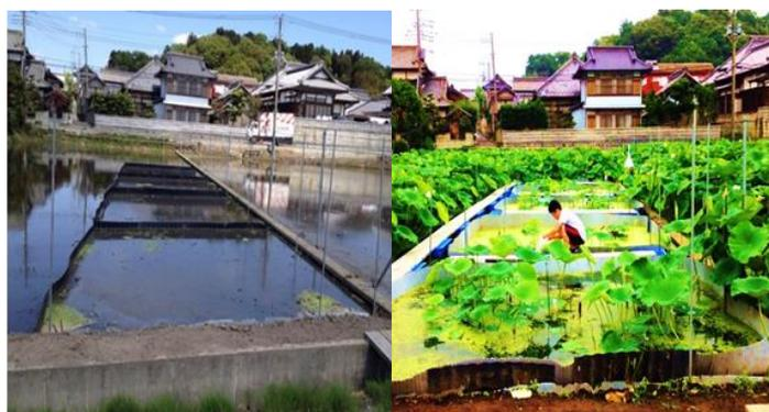
図(2)-1 波板で建設した実験区画（1区画20 m<sup>2</sup>）（左）および実験風景（右）
