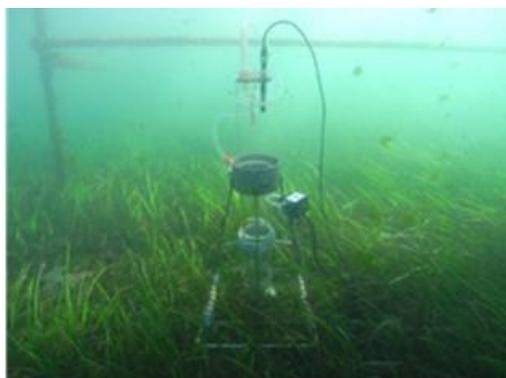
図(4)-3 アマモ場に設置したチャンバー
