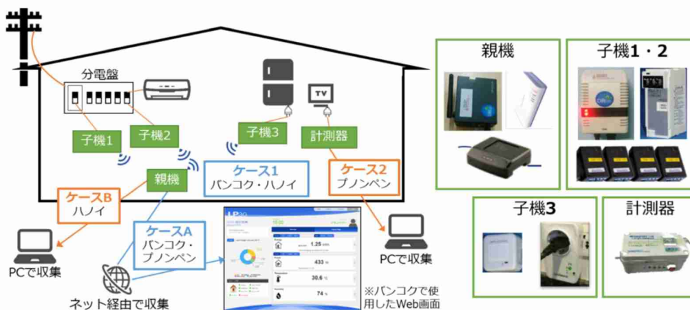
図2 計測システムの概要図
