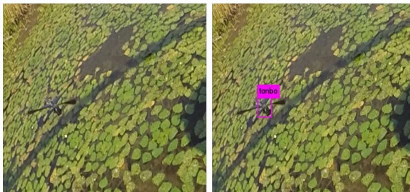
図(3)-16 ディープラーニングを用いたトンボの検出例。左は元画像、右の赤枠（バウンディングボックス）が検出部。
