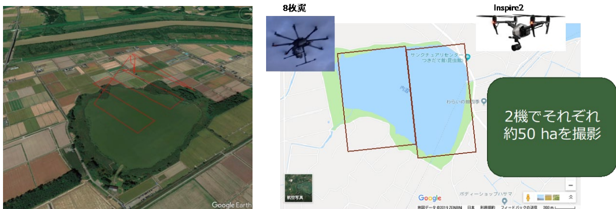
図(2)- 10 左は宮島沼で撮影を行う場合の飛行ルート（赤線）で、右は内沼を2機で分担して撮影する際の撮影範囲分担（2019年2月実施）。
