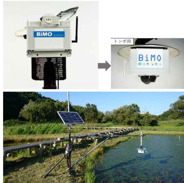
図(3)-6 トンボ用カメラユニットと設置例。マガン用カメラユニットからシェードやワイパー類を除去し、ユニット内の冷却方式を変更した。
