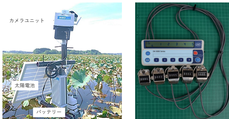
図(3)-5 内沼（宮城県）の湖心にカメラユニットを設置した例（左），ポイントセンサス用に製作したデジアナカウンター（右）。
