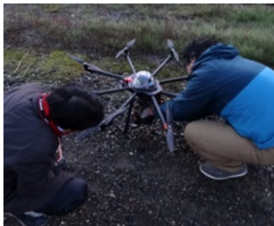
図(2)- 4 本研究で開発した8枚翼のドローン
