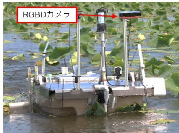
図(1)-8 画像入力用RGBDカメラを設置したロボットボート
