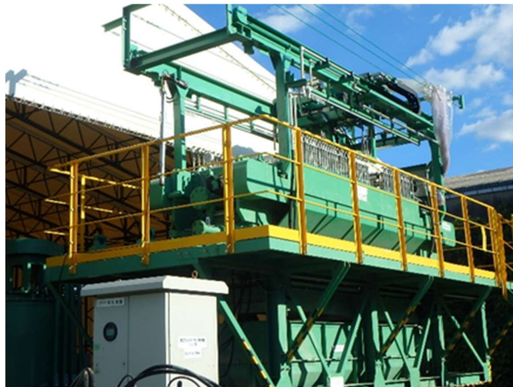
図 3.15 ろ室容量 1\text{m}^3 の高圧フィルタープレス（りんかい日産所有テスト機）
