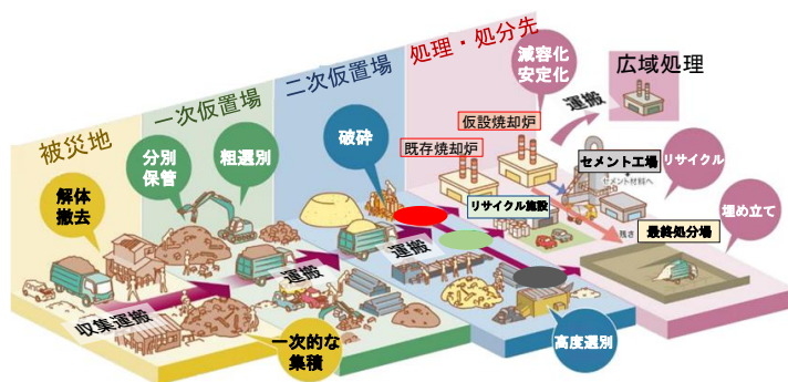
図1.2モデル化する全処理プロセス（環境省H.P.の図 35) ）に加
