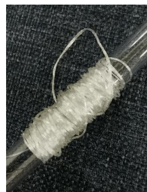
写真1-2. イタコン酸/HMDA/11AUA (50/50/50)の組成で大量合成したNylon6i, 11-50%の外観(左:合成直後の写真 右:条件最適化後に得たサンプルを繊維化したもの)
