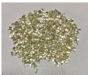
写真1-3. イタコン酸/HMDA/11AUA (12.5/12.5/75)の組成で最適化条件で技術移転により作製したNylon6i, 11-75%樹脂の外観
