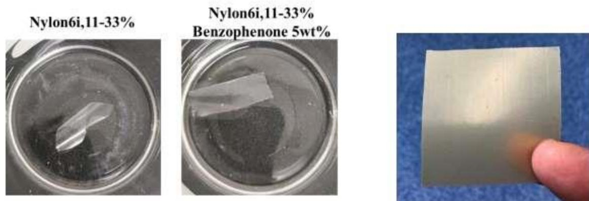
写真1-6 Nylon6i, 11-33%とベンゾフェノンとのコンポジットフィルムの写真
