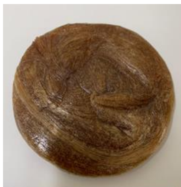
写真1-2. イタコン酸/HMDA/11AUA (50/50/50)の組成で大量合成したNylon6i, 11-50%の外観(左:合成直後の写真 右:条件最適化後に得たサンプルを繊維化したもの)
