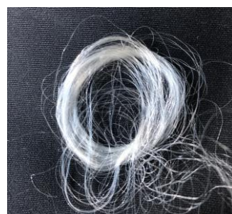
写真1-3. イタコン酸/HMDA/11AUA (12.5/12.5/75)の組成で最適化条件で技術移転により作製したNylon6i, 11-75%樹脂の外観
