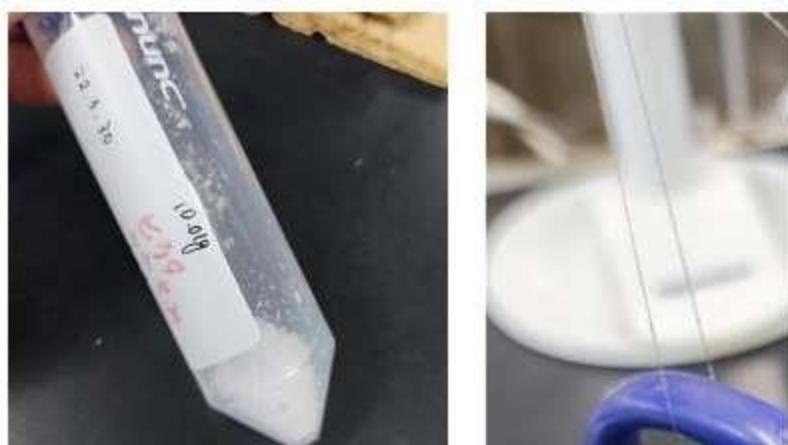
写真1-5. 非可食バイオマスから得たイタコン酸の写真（左）とそれから得られたNylon10i繊維の写真（0.1φ程度の良好な繊維が得られている）（右）
