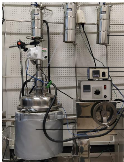
写真1-1. バイオナイロンを大量合成するための10L反応容器（本体は左
