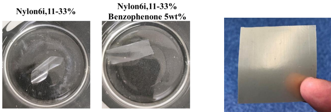
写真1-6 Nylon6i, 11-33%とベンゾフェノンとのコンポジットフィルムの写真
