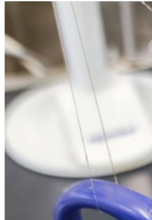
写真1-5. 非可食バイオマスから得たイタコン酸の写真（左）とそれから得られたNylon10i繊維の写真（0.1φ程度の良好な繊維が得られている）（右）
