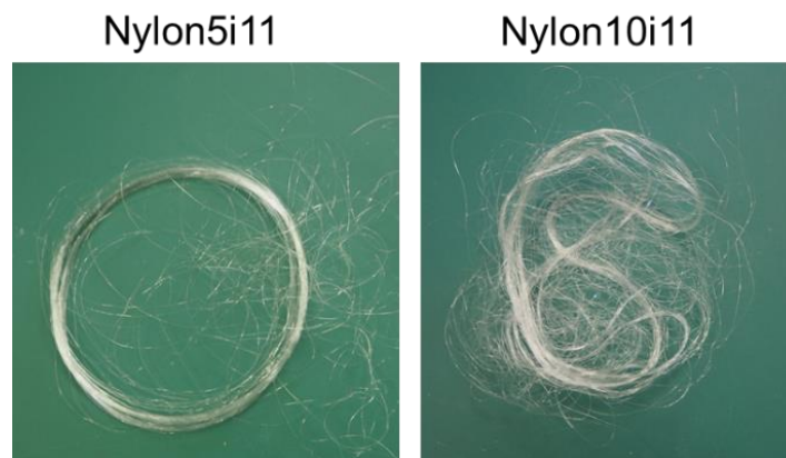
写真1-4. バイオ由来100%のバイオナイロン細繊維(0.015φ)の写真(左:Nylon5i, 11 右:Nylon10i, 11)
