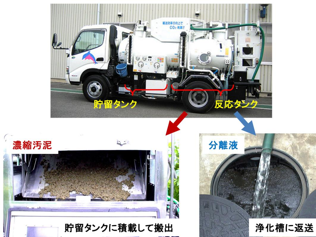
図1-1 濃縮車を使用した清掃の概要
