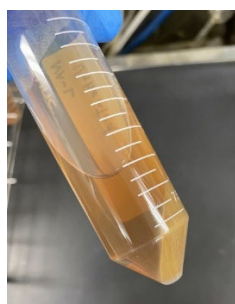
図20 耐水化した木粉シートを 0.1 M NaOH に浸漬して解体し遠心分離した様子
