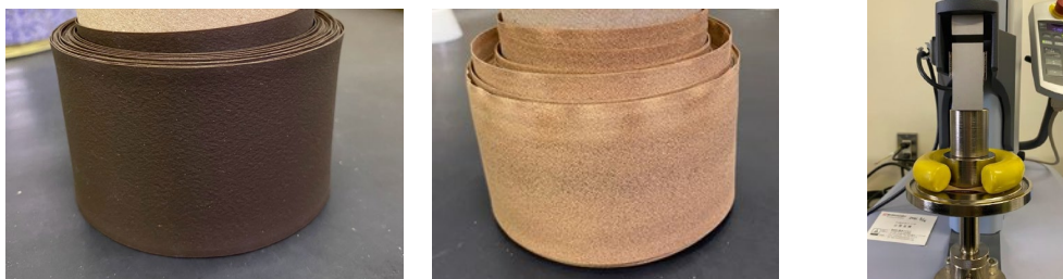
図3 NH 4 -CMCを助剤として成形した紙粉シート（左）、木粉シート（中）、表面粘着性試験（右）
