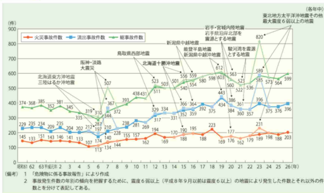
図(1)-1 危険物施設における火災及び流出事故の推移 1)
