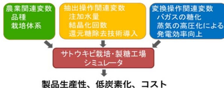
図(2)-4 サトウキビ栽培・製糖工場シミュレータ（業績1）の概要
