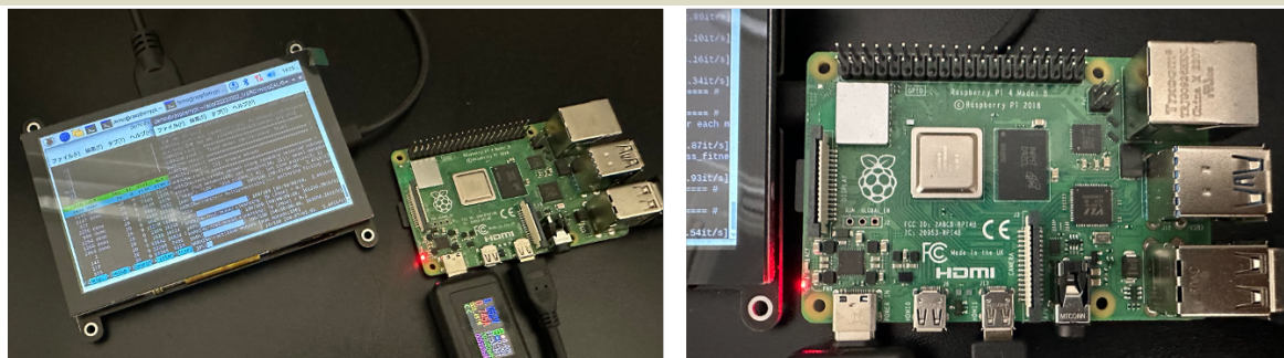
図-0.11 エッジデバイス(Raspberry Pi)への実装とデモ動作の様子
