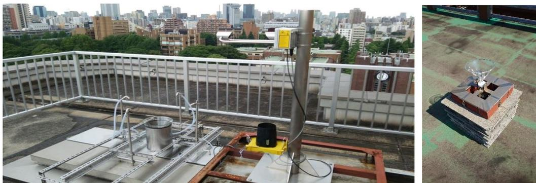
図(1)-6: 東京の観測で用いた自動降水採取装置（東大本郷キャンパス理学部1号館:左）と沖縄の観測で用いた手動降水採取装置（沖縄県辺戸岬観測所：右）
