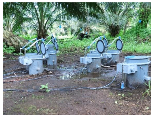
図(1)-3 自動開閉式チャンバーシステム（SBWサイト）
