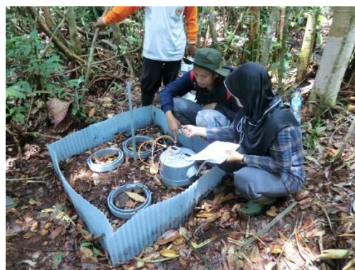
図(1)-4 マニュアルチャンバーによる測定の様子（PUFサイト）
