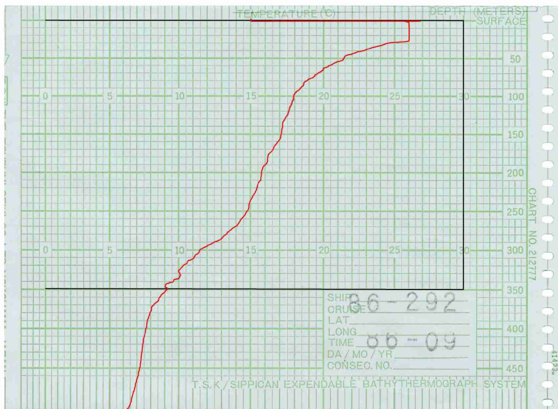
図(2)-1: ラスターライズしたXBT自記紙(TSK/Sippican Chart No. 212777)上の既知値(基準点)四点のトレース結果(黒色)と水温プロフィールのトレース結果(赤線)(気象庁凌風丸1986年9月14日の観測)
