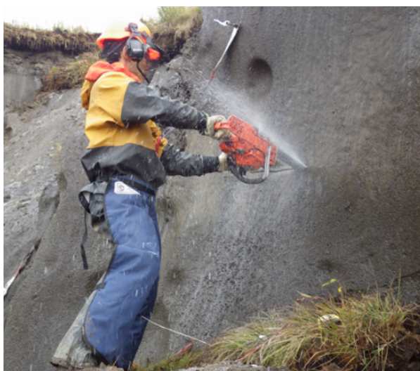
図(2)-2 Anak2 におけるチェーンソーを用いた地下氷のサンプリング
