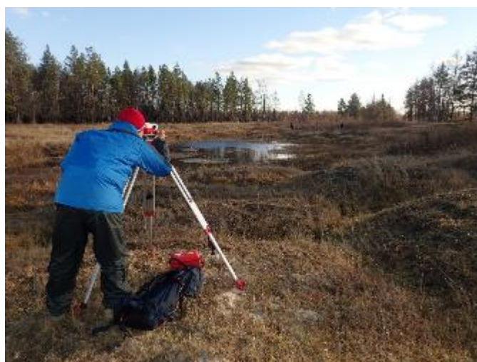
図(1a)–18 Mayya近郊の調査地における測量。サーモカルスト沈下が不均等に起こった結果、亀の甲羅状に凹凸ができた陥没地形（バイジャアライヒ）
