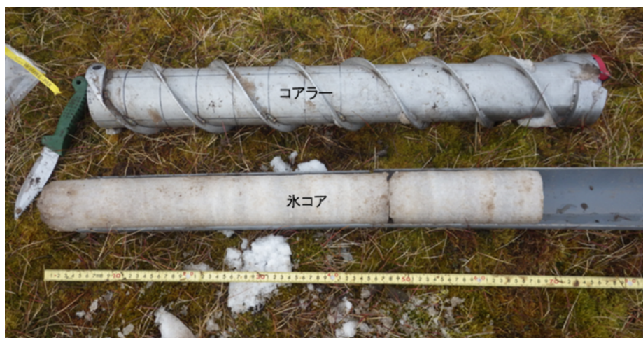
図(2)-3 コアラーを用いて Stuphallet で採取された地下氷コア
