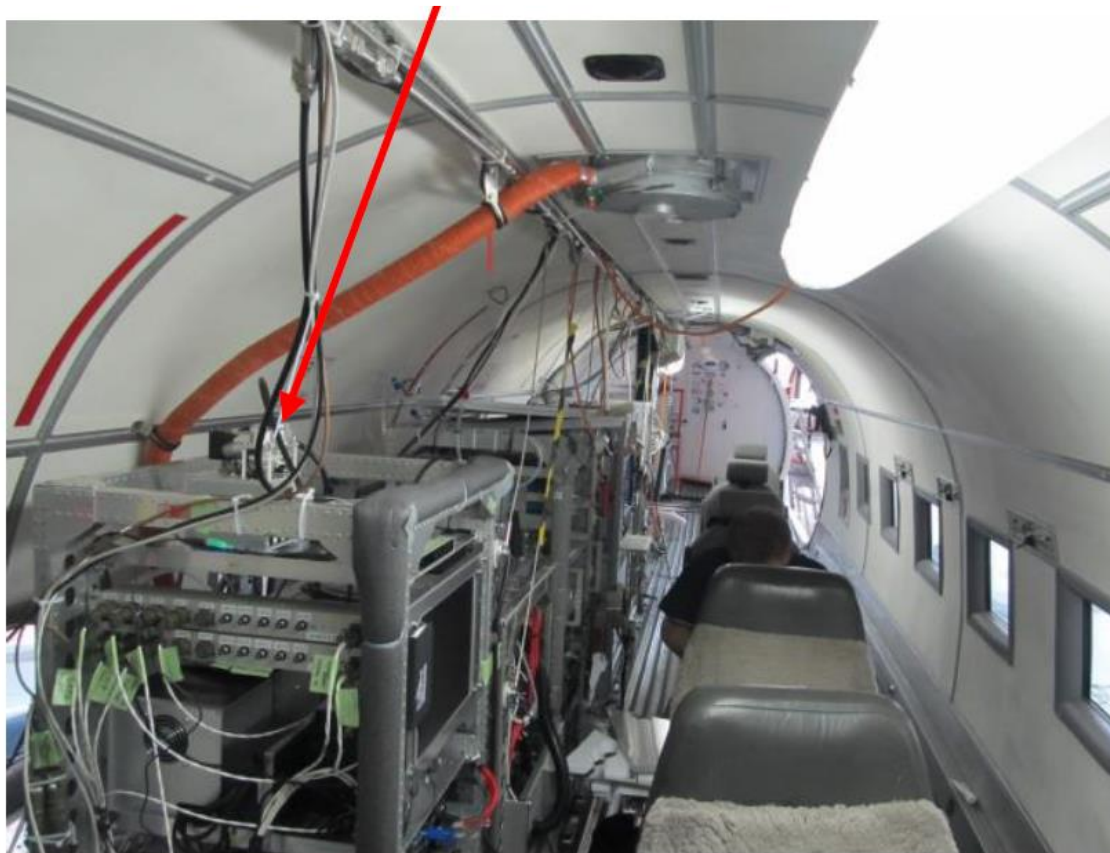
写真3.3.1 グリーンランド上空で行った電子顕微鏡用サンプラー（AS-24W；赤矢印）を使用して行った航空機観測 “Polar Airborne Measurements and Arctic Regional Climate Model Simulation Project”（PAMARCMiP2018）。
