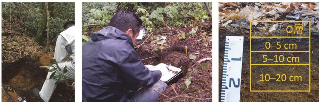
図3.4.4 土壌掘削による土壌試料の採取（チャンバー外）
