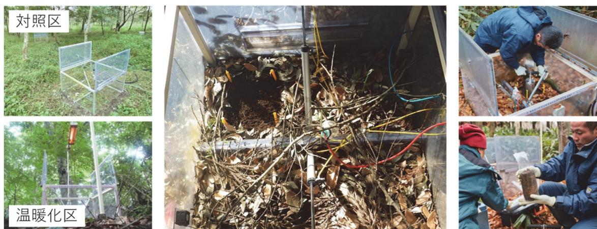
図3.4.2 チャンバー内におけるリター及び土壌試料の採取
