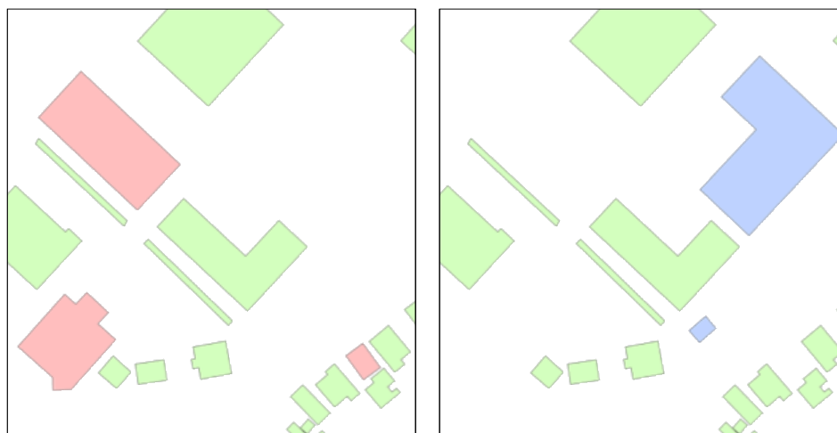
図3.3.3 着工建築物・解体建築物抽出の例
