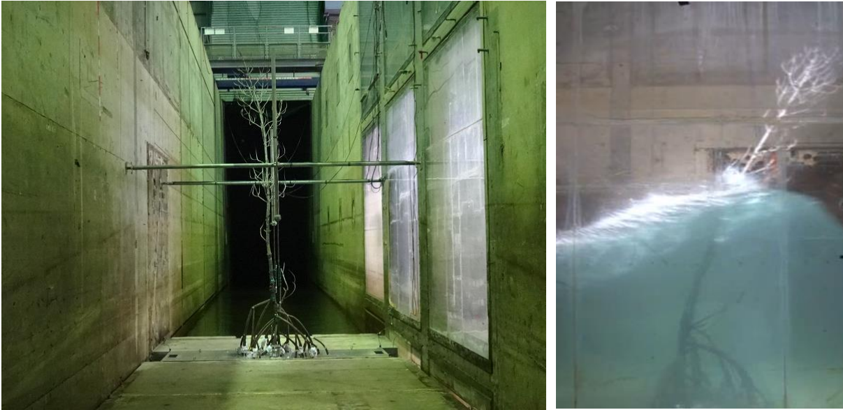
図3.6.7 大規模水理実験の試験体設置状況及び水理実験のスナップショット
