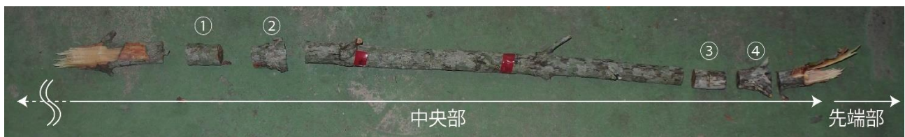
図4.6.10 試験体の密度及び含水率の確認箇所
