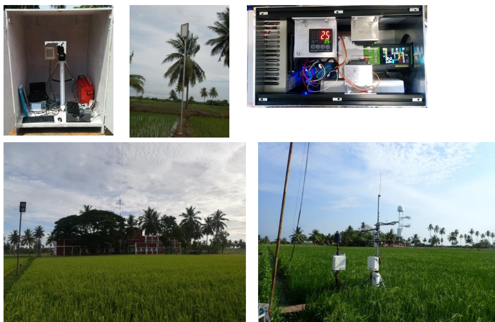
図4. 1 TRRIにおける大気メタン濃度、メタンフラックス、環境要因の連続測定システム 大気メタン濃度の連続測定システム（上段左）、反射板（上段中央）、専用三脚ケース内部（上段右）、 大気メタン濃度の観測機器類の全景（下段左）、メタンフラックスと環境要因の連続測定システム（下 段右）
