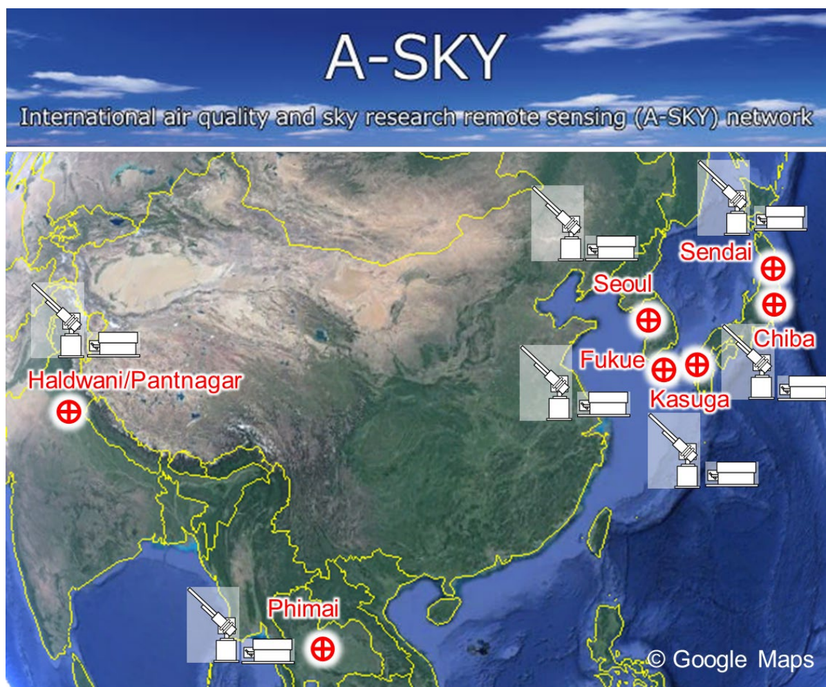
図3.2 国際観測網に展開させるA-SKY観測網の配置図、A-SKYは、スカイラジオメーターとMAX-DOASの両方を配備することとし、ライダーがあれば望ましい。なお、千葉サイトと福江サイトにおいては、PM 2.5 計とBC計も配備されている。
