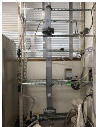
図2.17 連続オゾン反応試験
