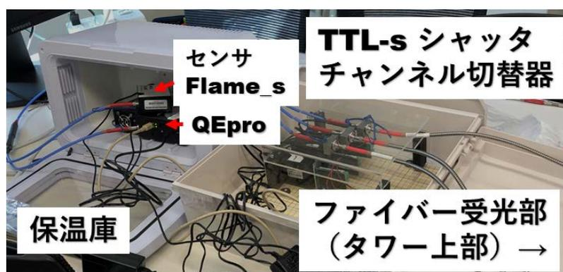
図 1.4 高分解能分光放射計を含む観測機器 (基盤部分)。実際の運用は蓋を閉じ、かつロッカーまたは建造物等に配置し測定環境を一定に保つ。
