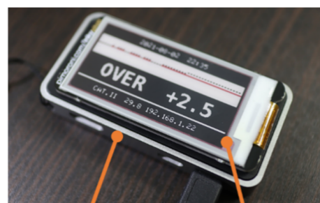
マイコン(WiFi&BT内蔵) Raspberry Pi Zero W 3色電子ペーパー
