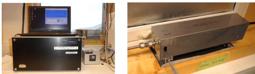
図-4.1 ノルウェー・スヴァールバル諸島のニーオルスンに設置されたCOSMOS。（左）黒い箱の右後方にある金属製のヒーターで、取り入れた大気を加熱し、ブラックカーボン以外のエアロゾル粒子を蒸発させて、COSMOS本体（黒い箱）で光吸収率の測定を行う。（右）ヒーターの拡大写真。
