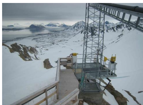
図-1.2 ゼッペリン山観測所のテラス上に設置された雲粒子測定装置（写真左の白い台上の装置）と降水粒子測定装置（写真右の白い台上の装置）。
