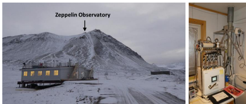
図-4.4 Zeppelin山観測所（左写真）に設置されている氷晶核粒子計測用の自動エアロゾルサンプリングシステム（右写真）の様子。本システムは、COSMOSと同じPM10インレットに接続されている。
