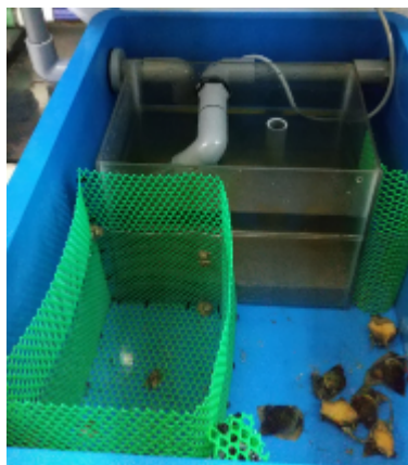
図1-5 ウバガイ・バイの流水式複合影響評価実験水槽内部の様子。奥の砂の入った小水槽内でウバガイを飼育し、手前でバイを飼育した。
