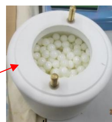
アルミナポットにYTZボールを充填した様子
