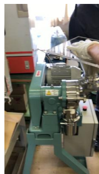
図1-2 浄水ペレットの粗粉碎に用いたハンマーミル
