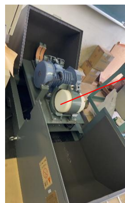
図1-3 振動ミル装置の外観と容器の写真
