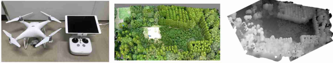
図 II-10 ドローン（Phantom 4, 左）とドローンによる空撮画像から作成した3次元データ（中央：色付きDSM, 右：DSM）
