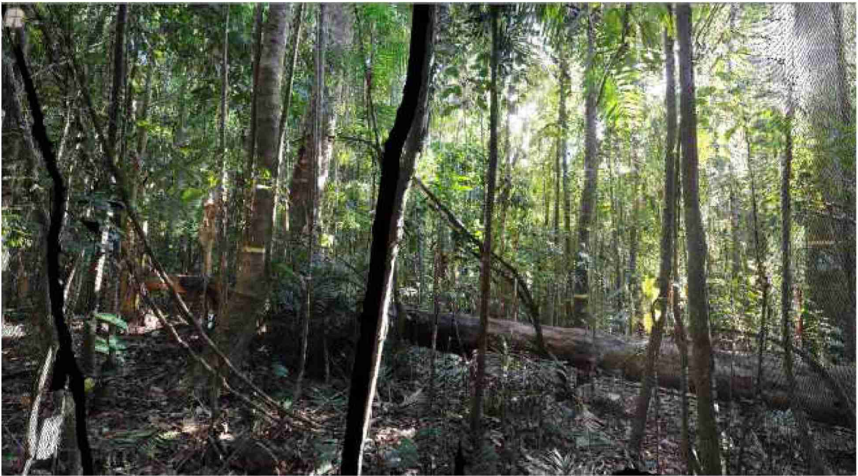
図Ⅱ-8 オーストラリアで取得した地上レーザーによる風倒木のサイトでの3次元データ。高密度点群データにカメラから取得した色を付けている。二次元の写真画像に見えるが、カメラによる写真撮影と同期してレーザー照射を行っているため、点群に色が付いた3次元データである。
